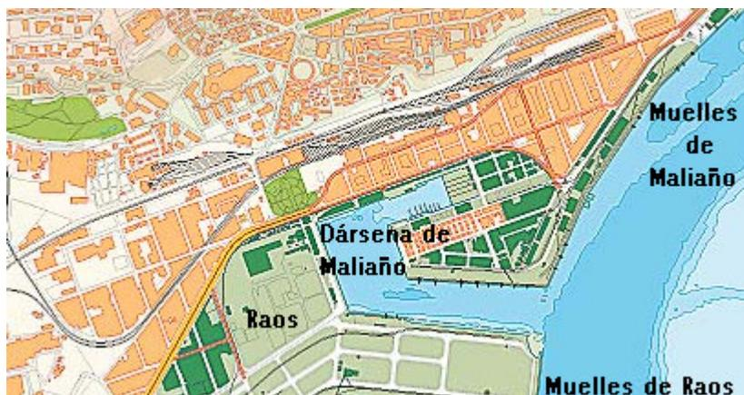
Siguiendo en esta dirección, se enlaza con el resto de los tramos del Muelle de Maliaño. Numerados del 9 al 1, están orientados en varias direcciones: el tramo 9 lo está al 43°/223° y al 032°/212° debido a un quiebro existente delante del noray 60. El calado varía de 5,5 a 7,0 m, concretamente delante de
