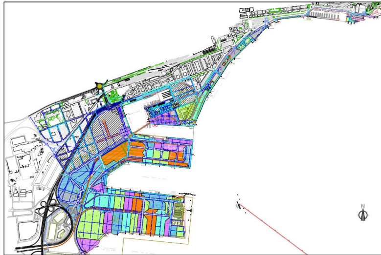
Figura: Plano de las cuencas de recepción de aguas pluviales y puntos de control de vertido
